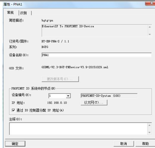
双击 **Ethernet (1): PROFINET-IO-System (100)** 总线，点击更新时间，双击设备，可以修改刷新的时间。
