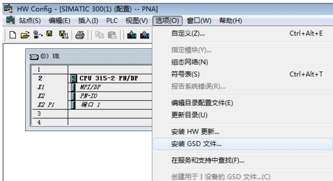
找到解压缩目录，点击确定，确定之后，BT-EN-PNA 的 GSD 文件就已经添加上了，点击关闭，结束 GSD 文件的安装。
