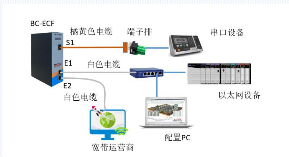
支持一种串口协议一种以太网协议的接线图
