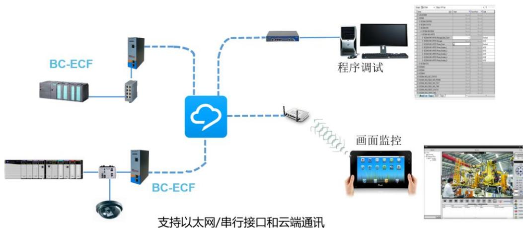
2) 多平台的数据监控模式：通过各种工业协议对现场采集到的数据进行标签自定义，并对这些标签进行报警阈值设定，数据逻辑运算。同时无需第三方组态软件和编程软件，实现各种终端（包括 PC 端，手机端，平板端）采用浏览器或者微信对实时数据/历史数据进行图形化显示，并且无需启动 VPN 的情况下，可对历史数据进行云端存储（支持用户本地下载）以及趋势图显示。同时还支持不同终端采用 MQTT 的 APP 对实时数据进行监视
