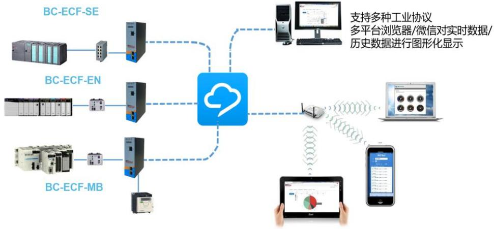
3) 实时数据协议转换模式：将不同的工业协议进行转化，可以统一转化为某些标准工业协议格式，例如，Modbus TCP, EtherNet/IP, OPC UA, 或者数据库格式（需根据客户要求进行定制），用户可统一采用某一种上位工业软件对现场不同设备数据进行监控，或者将数据按照数据库格式直接导入 MES 服务器系统。也可以完成不同品牌，不同协议的远程设备之间的通讯。
