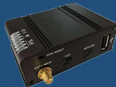
BW-24NM 工业电台是 Beacon Global Technology 旗下 802.11 电台系列中的一员，体积小巧，适用于各类安装空间有限的工业现场领域。电台具有双以太网接口和串行接口（RS232），可以和各种 PLC 以及现场 RTU 设备建立通讯。BW-24NM 工业电台支持多种加密技术，同时可以支持多 SSID 功能。
